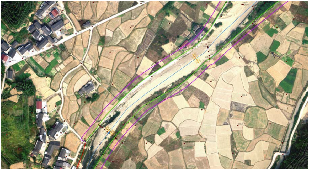
堤脚线外延 10 米划定
